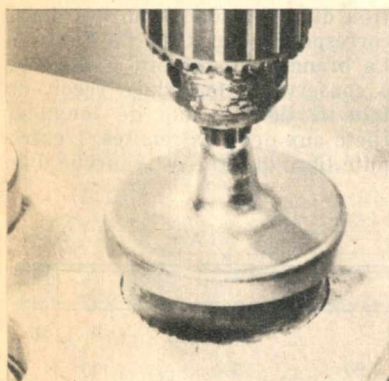
Montage d'un foret spécial de grand diamètre.
